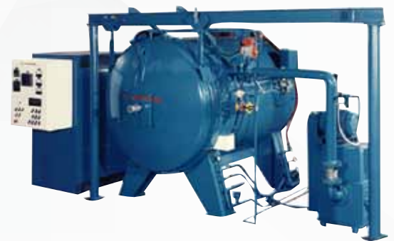
Horno Por Lote el sistema modular al vacío ofrece gran versatilidad para una alta gama de procesos de tratamiento térmico
