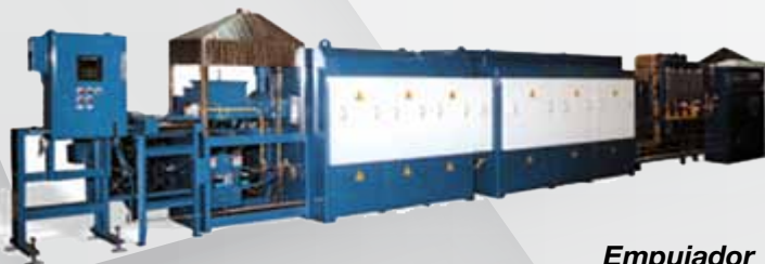
Empujador para aplicaciones de alta temperatura de hasta 3000°F
